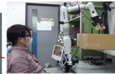
(d) Robotic arm grasping of the user selected object
